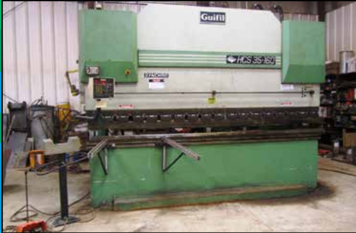
GUILFIL 176 TON X 12' SYNCHRO CNC HYDRAULIC PRESS BRAKE
