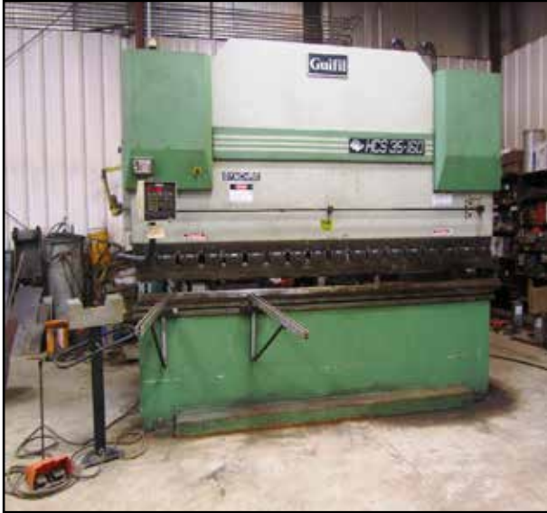
GUILFIL 176 TON X 12' SYNCHRO CNC HYDRAULIC PRESS BRAKE
