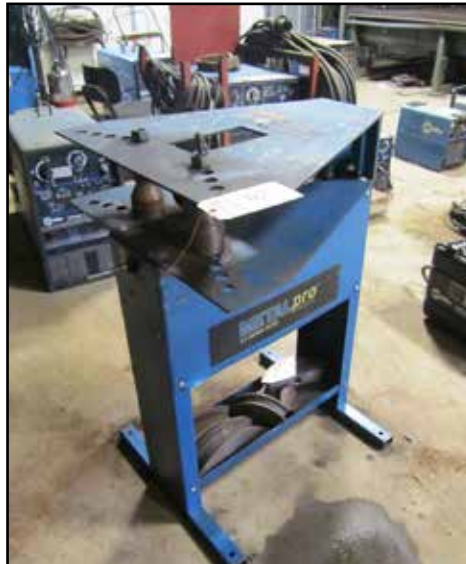
METAL PRO EZBEND 8000 HYDRAULIC TUBE BENDER
