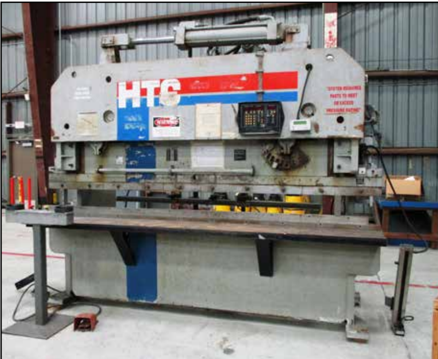
HTC 100 TON X 10' 2-AXIS CNC HYDRAULIC PRESS BRAKE
