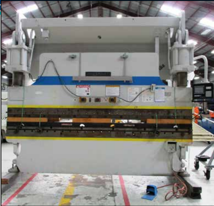
CINCINNATI 230 TON X 12' 2-AXIS CNC HYDRAULIC PRESS BRAKE
