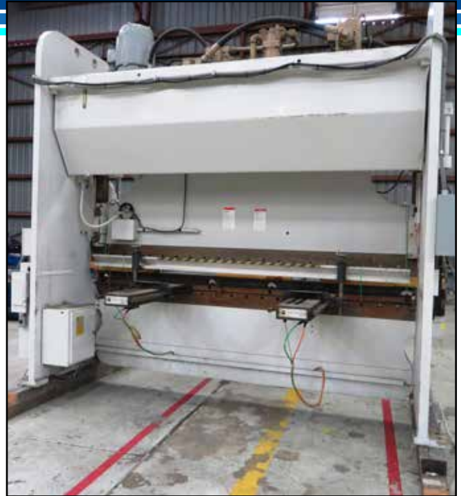
CINCINNATI 230 TON X 12' 2-AXIS CNC HYDRAULIC PRESS BRAKE
